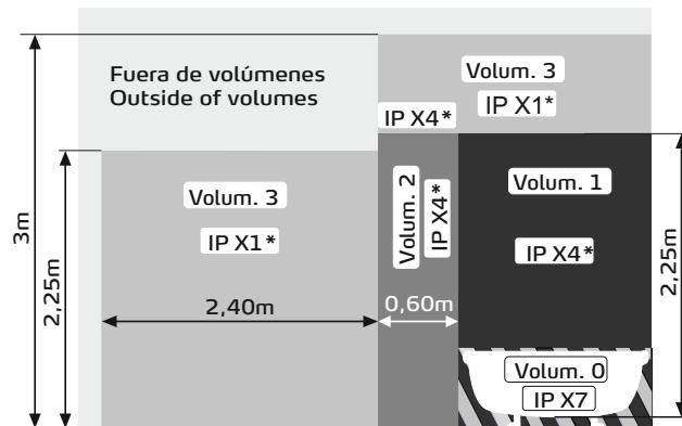
\*UTE C 15-801 : 2012. Dans le cas des locaux d'habitation, des locaux recevant une baignoire ou une douche et des prises de courant inférieur ou égal à 32 A le circuit correspondant doit être protégé par un dispositif à courant différentiel-résiduel (DDR) inférieur ou égal à 30 mA.
